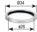
Art. 00040 Anello fissaggio piastra per deviatore Plate fixing ring - diverter Plattenbefestigungsring für Umstellventil
